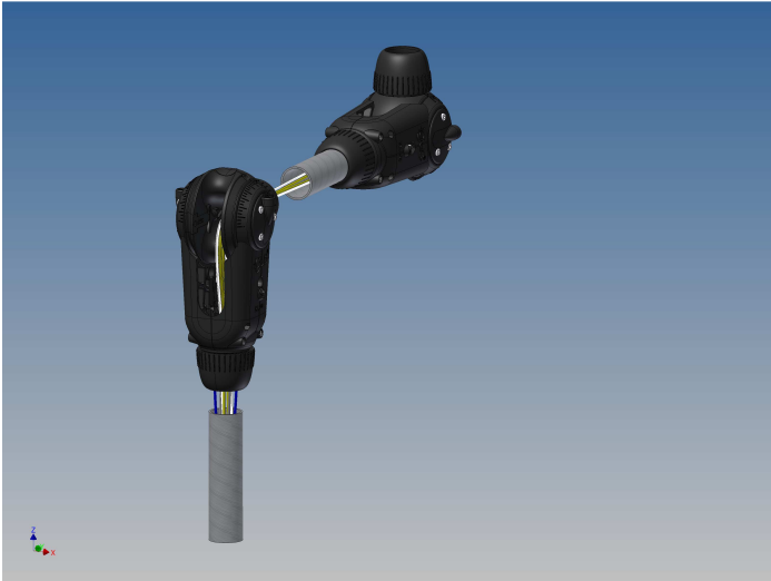
Bild 1: Zusammenbau und Seilverlauf bei 2 Gelenken. Gelb: Seilpaar Schwenkbewegung Gelenk Nr. 2 Weiß: Seilpaar Drehbewegung Gelenk Nr. 2
